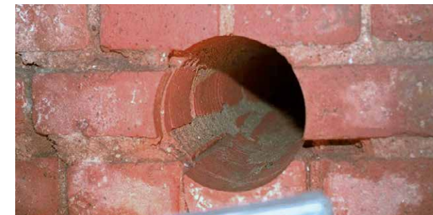
Puursüdamiku eemaldamine tellismüüritisest
