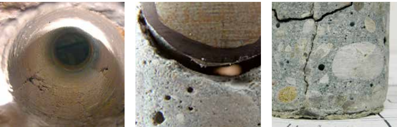
Puursüdamiku eemaldamine: tühimike, pragude kulgemise, niiskuseisundi ja saastumise kindlaksmääramine
