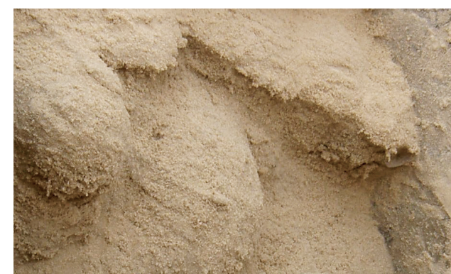
Joonis 6. Pärast injektsoontäitmist tekkinud liiva-geeli injektsoonkardina näide
